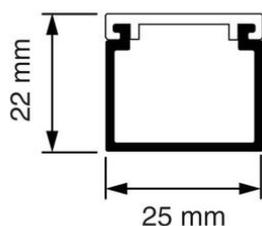
Les conduits de câbles Attema sont disponibles de très petits à très grands. La plupart des mini-tubes sont faciles à monter grâce à la bande adhésive double face de haute qualité. Le type TK n'est pas équipé d'un couvercle. Le type SK est équipé d'un couvercle à charnière avec fermeture solide. Le MK10 se compose d'un tube et d'un couvercle "click".
