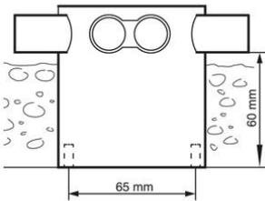
Les boîtes de jonction en béton ont été spécialement conçues pour la mise en place d'installations traditionnelles dans les plafonds en béton et sont équipées de sorties combinées pour les tuyaux de 16 et 19 mm. Les boîtes de jonction en béton peuvent être utilisées dans : - les sols pleins et les dalles à âme creuse, ou - les conduits de dalles larges.
