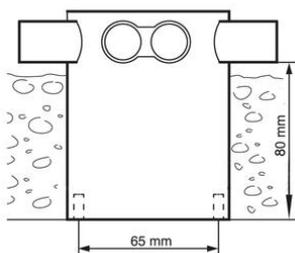
Das Kitvast®-Betonbausystem von HELIA wird in Betonwerken eingesetzt. Nachdem die Markierungen angebracht wurden, werden die Schachtel und der Deckel eingeklebt. Nach dem Ausschalen werden die Abdeckung und der Kleber von der Schalung entfernt. Kitvast® ist ein flexibles System, das auf allen Untergründen angebracht werden kann, ohne die Schalung zu beschädigen. Geeignet für Stahlschalungen, kein Bohren erforderlich, daher keine Beschädigung der Schalung, ideal für Betonwerke.
