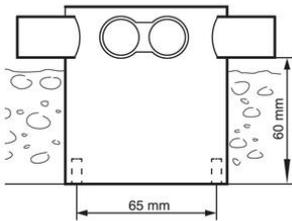
Das Kitvast®-Betonbausystem von HELIA wird in Betonwerken eingesetzt. Nachdem die Markierungen angebracht wurden, werden die Schachtel und der Deckel eingeklebt. Nach dem Ausschalen werden die Abdeckung und der Kleber von der Schalung entfernt. Kitvast® ist ein flexibles System, das auf allen Untergründen angebracht werden kann, ohne die Schalung zu beschädigen. Geeignet für Stahlschalungen, kein Bohren erforderlich, daher keine Beschädigung der Schalung, ideal für Betonwerke.
