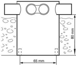
Die Betonabzweigkästen wurden speziell für den Einbau traditioneller Installationen in Betondecken entwickelt und sind mit Kombiabgängen für 16 und 19 mm Rohre ausgestattet. Die Betonabzweigkästen können eingesetzt werden in: - Massivdecken und Hohlkörperplatten oder - breiten Deckenkanälen.
