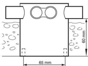
Die Betonabzweiggkästen wurden speziell für den Einbau traditioneller Installationen in Betondecken entwickelt und sind mit Kombiabgängen für 16 und 19 mm Rohre ausgestattet. Die Betonabzweiggkästen können eingesetzt werden in: - Massivdecken und Hohlkörperplatten oder - breiten Deckenkanälen.
